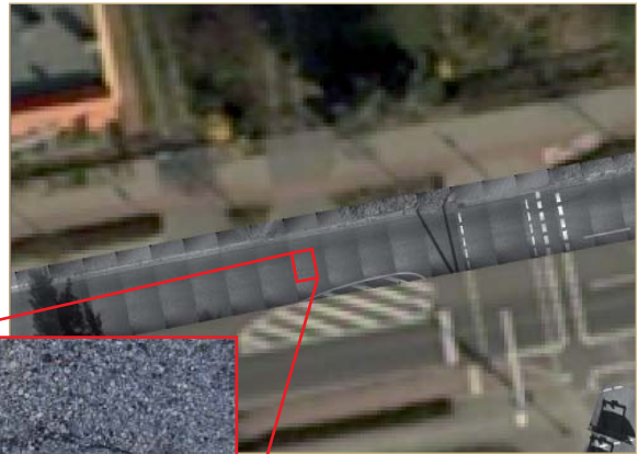
Überlagerung von Luftbild und geo-referenziertem Heck-Kamerabild
