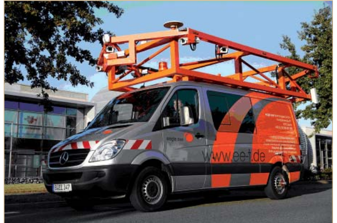
Messfahrzeug von eagle eye technologies mit 12 Gigabit-Ethernet-Kameras
